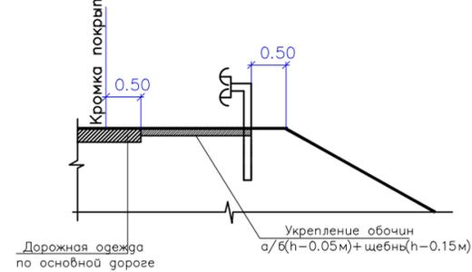
Экспликация к разрезу Б-Б
