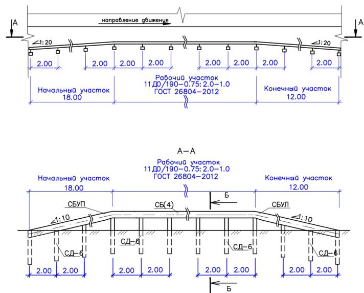
Конструкция одностороннего барьерного ограждения Б-Б
