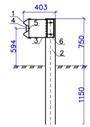
Схема установки барьерного ограждения
