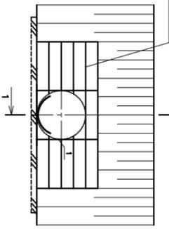
СХЕМА ЗАСЫПКИ ТРУБЫ
