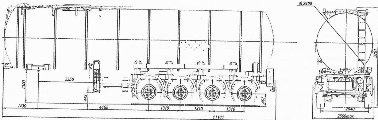
Конструкция цистерны выполнена из низколегированной стали 09Г2С, самонесущей конструкции, предназначена для перевозки, временного хранения темных нефтепродуктов (горячий битум, смолистые масла, мазут, нефть и пр.), транспортируется тягачом колесной формулой 6х4 российского или иностранного производства
