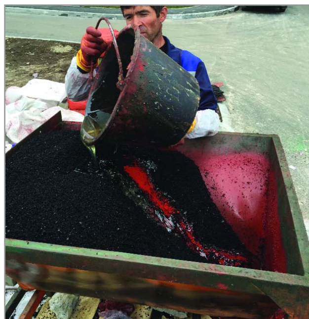
Смешивание в миксере резиновой крошки из отработанных шин, связующего полимерного состава и красителя
