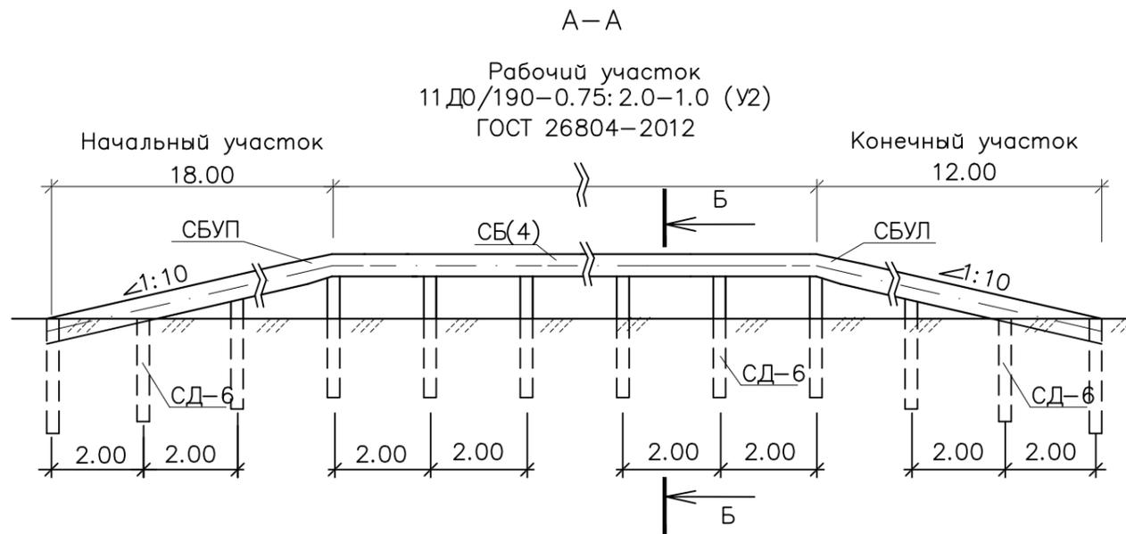
Схема установки барьерного ограждения
