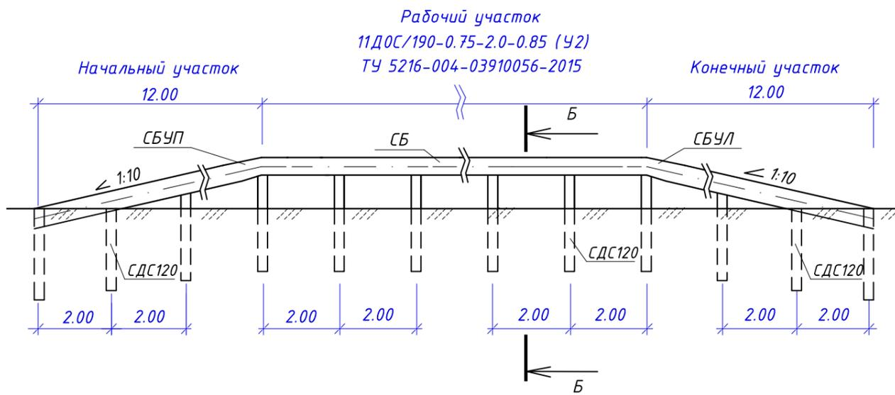
Экспликация к разрезу Б-Б
